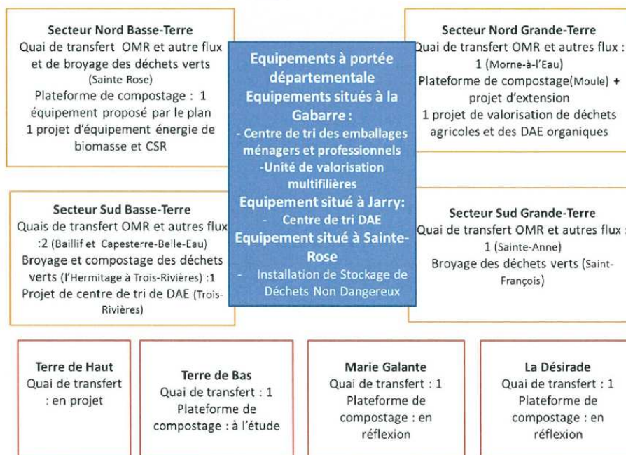
Figure 9 : Equipements retenus par le plan de prévention et de gestion des déchets non dangereux – Source : [CRG17]
